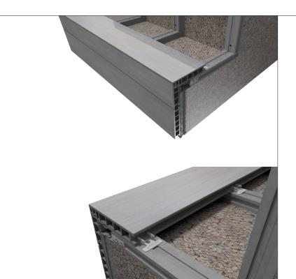
Fijado el mamperlán, se colocaría la siguiente tabla para, en este ejemplo, cubrir por completo la huella del primer peldaño. La fijación de esta tabla se realiza también mediante la utilización del clip Tarimatec.
