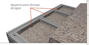
En la imagen anterior, vemos el detalle de la fijación del rastrel de borde con escuadras, además de ver como permite la evacuación de agua y en la siguiente imagen vemos como el rastrel de borde es coplanar en dos de sus caras tanto con los rastreles de huella como los de contrahuella.
