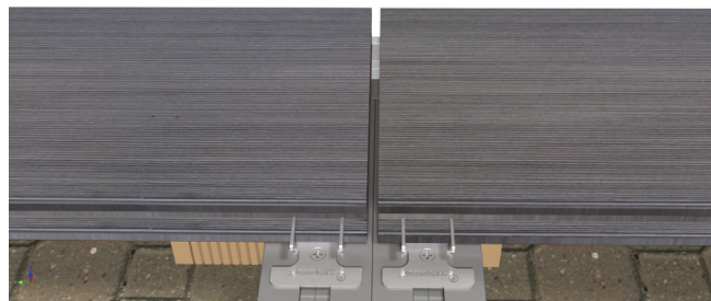
18. Doble rastrelado entre testas con un clip para cada lambr.
