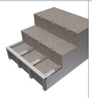
Se atornillan los rastreles de la huella del primer peldaño utilizando el tornillo de golpeo anteriormente visto y se coloca el rastrel del borde del peldaño que va sujeto a los rastreles colocados en la huella mediante escuadras a ambos lados del rastrel.
