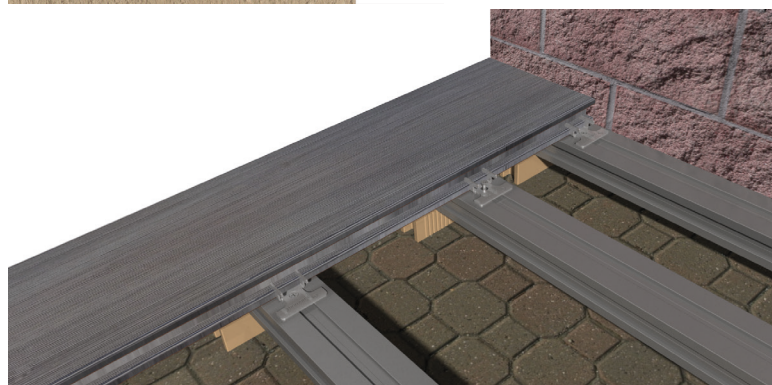
20. Detalle lapa instalada en rastreles de extremo de instalación.
