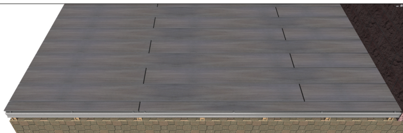
54. Perfil de inicio atornillado sujetando la última tira de laminas.
