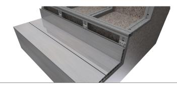
Del mismo modo que en el primer peldaño, colocaríamos el adhesivo MS en el rastrel del borde del peldaño, y colocaríamos el manperlán. Para la pieza de la contrahuella, en lugar del clip convencional, se podría emplear también clip de inicio como se aprecia en la siguiente imagen rodeado en rojo.
