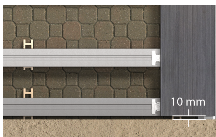
38. Separación de la testa de la tarima respecto de la pared.
