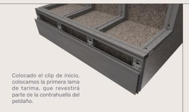
Esta lama de tarima es sujeta por su aleta superior con clips Tarimatec. Tanto el clip de inicio como el clip Tarimatec, se fija al rastrel de aluminio con el tornillo 7504P 4,2 x 25 mm. Colocada la primera lama, vemos que el espacio en la contrahuella es insuficiente para el alojamiento de una lama completa, por lo que en este punto, debemos realizar la mecanización y ensamblaje del manperlán.
