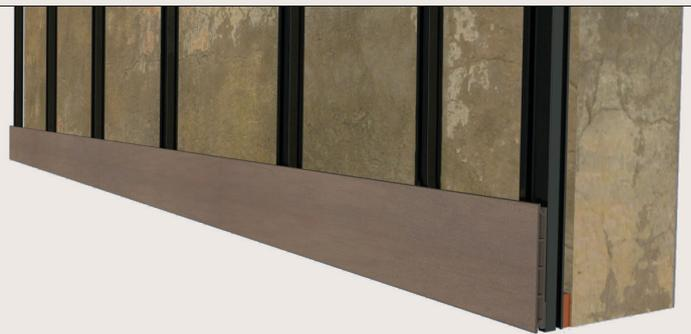
La parte superior de la tabla, la sujetamos con el clip de montaje rápido Mont Blanc. Este clip se inserta en el canal del rastrel con un simple giro y lo encajamos en ala de sujeción del perfil Mont Blanc hasta escuchar "clic". Aunque el clip va provisto de agujero para alojar un tornillo, de momento, no será necesario atornillar, lo que reduce considerablemente el tiempo de montaje.
