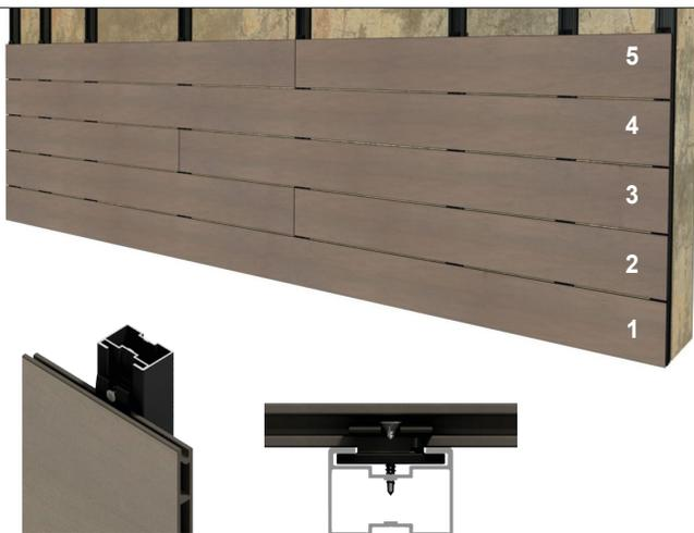
El tornillo que emplearemos será DIN 7504 P A2 4,2 x 25 mm, y se atornillarán cada uno de los clips colocados sobre la quinta fila de perfil Mont Blanc. Solo será necesario atornillar los clips al rastrel cada 5 filas de perfil instalado. p.e. en una instalación de 23 filas de perfil Mont Blanc, solo será necesario fijar el clip al rastrel en 4 filas (filas 5, 10, 5 y 20).
