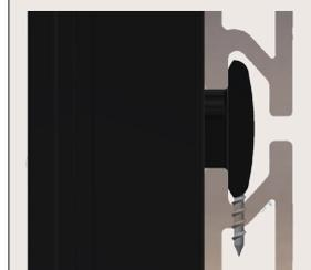
Este sencillo sistema, permite la dilatación y contracción de la pieza, pero evita que debido a estas dilataciones y contracciones, la pieza se pueda ir desplazando lateralmente, provocando que, además de variar el aspecto visual de la fachada, alguna testa pueda perder el contacto con el clip.
