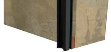
Los rastreles de la instalación, se fijan al sustrato mediante tornillo-taco de golpeo de al menos 6 mm. Estos tornillos deben ser de acero inoxidable AISI 304, y AISI 316 si se la instalación se realizara en ambientes marinos.
